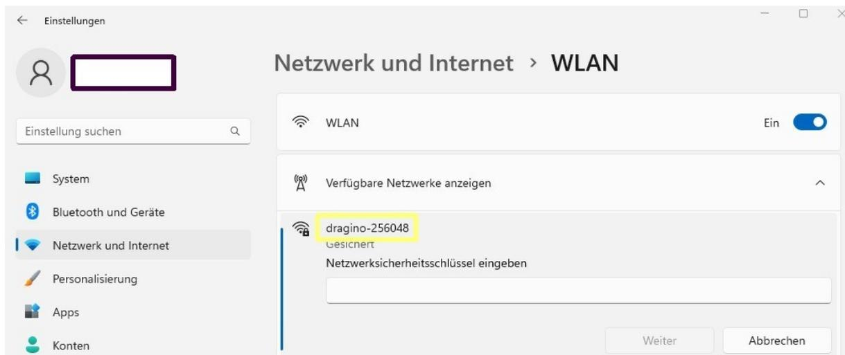
Damit sich der PC über WLAN mit dem Gateway eGW-LTE 052 verbinden kann muss der Netzwerksicherheitsschlüssel eingegeben werden. Dieser setzt sich aus den Buchstaben „dr%“ und der sechsstelligen Kennung des Gateways zusammen.
