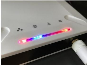
An der Oberseite des Gateways befindet sich eine LED-Leiste, die mit insgesamt vier LED's bestückt ist.
