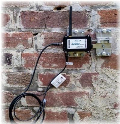
Aufgrund der kompletten Integration des Funksystems mit der dazugehörigen Sensorik ist die Installationszeit auf ein Minimum begrenzt.
