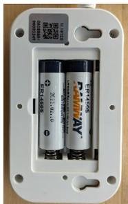
Der Batteriewechsel erfolgt über die auf der Rückseite angebrachte Klappe. Hierzu kann das Batteriefach werkzeuglos geöffnet werden. Eine neue Batterie kann jederzeit bei der Firma **FrimTec** bestellt werden.
