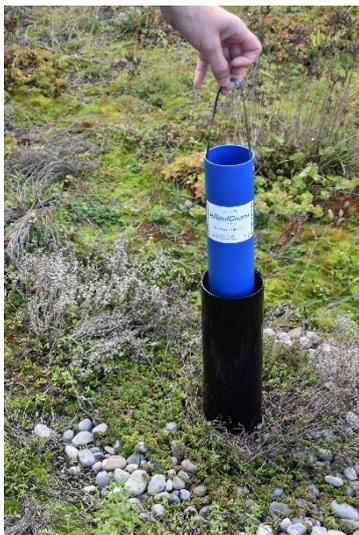
Aufgrund der kompletten Integration des Funksystems mit der dazugehörigen Sensorik im sogenannten **F<sub>T</sub>**-Montagerohr ist die Installationszeit auf ein Minimum begrenzt.
