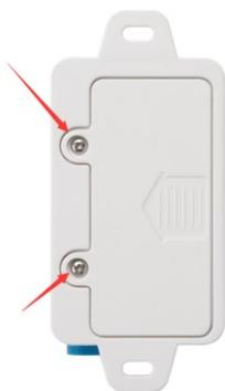
Der Batteriewechsel erfolgt über die auf der Rückseite angebrachte Klappe. Hierzu sind beide Schrauben zu lösen. Eine neue Batterie kann jederzeit bei der Firma **FrimTec** bestellt werden.
